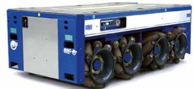
Sondergeräte mit dem Omnidrive-Carrier-System erzielen eine extrem hohe Wendigkeit.
