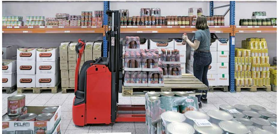
Die Modelle D06 bis D10 können gleichzeitig Traglasten zwischen 0,6 t und 1,0 t auf dem Freihub sowie 1,0 t zusätzlich auf dem Initialhub bewegen. Die Fahrzeuglänge beim D06 beträgt dank kompakter Lithium-Ionen-Batterie gerade einmal 592 mm. Ein Novum: der Doppelstockbelader D08 M mit Monomast. Das Modell mit 1.590 mm Hubhöhe verfügt dank kompakter Lithium-Ionen-Batterie über ein komprimiertes Design; speziell für Anwendungen im Einzelhandel. Alle Doppelstock-Modelle
