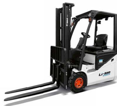
ze, des stabilen Fahrgestells, des langlebigen Masts und der Batterieabdeckung aus Metall – zusammen mit hochwertigen Komponenten von führenden Herstellern – reduzieren diese Modelle die Wartungskosten und gewährleisten eine ständige Einsatzbereitschaft. Das EPS-System in Verbindung mit der proportionalen Hubfunktion sorgt für reibungslose und mühelose Stapelvorgänge.
