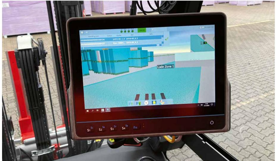
Materialbewegungen ohne manuelle Buchungen oder Barcode-Scans im Staplerleitsystem erkannt werden. So werden Fehler vermieden und effektiv Kosten gespart. Die Kombination aus RTLS und Sensorik stellt speziell im Blocklager einen wahren Intralogistik-Boost dar. Basierend auf der stets aktuellen Position der Fahrzeuge ermöglicht das ABF-Staplerleitsystem lückenlose und
