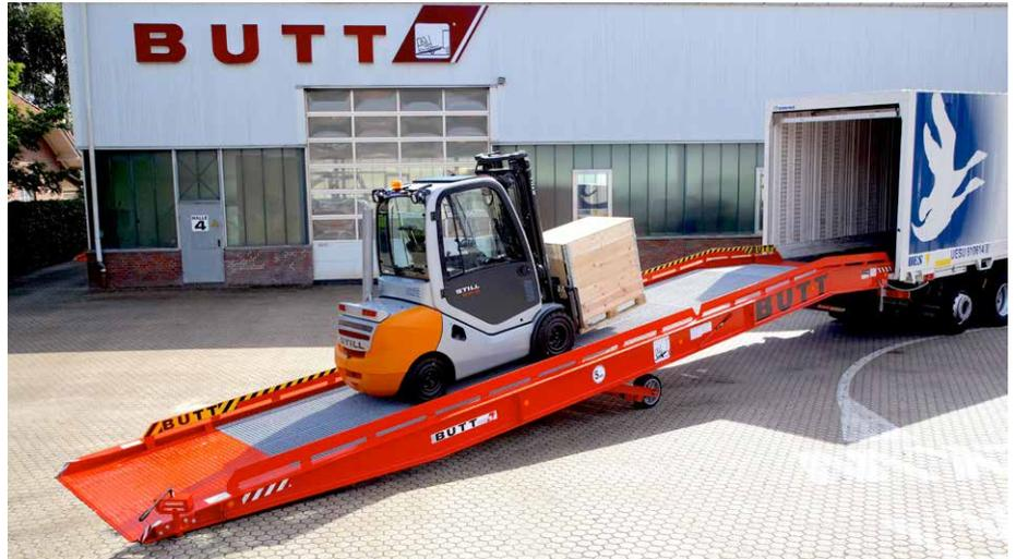
ten-Schnellverschluss gelöst und das Hydraulikventil geschlossen. Die Rampe wird mittels hydraulischer Handpumpe hochgepumpt, so dass der LKW nach Lösen der Sicherheitsketten vorfahren kann. Die Rampe ist bereit für den nächsten Ladevorgang. Zum Verfahren ist die Rampe mit einer kardanisch aufgehängten Gabel-
