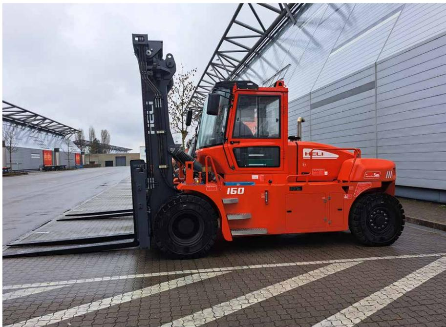
Bild 1: Der neue 16-Tonner hat ein Triplex-Hubgerüst für bis zu 6.500 mm Hubhöhe. Ihn treibt ein 140 kW starker Cummins-Motor (Stufe V) an.
