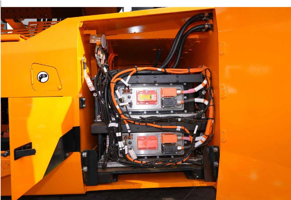
Blick auf die im Fahrgestell montierten Lithium-Ionen-Batterien mit 184 kW Kapazität.
