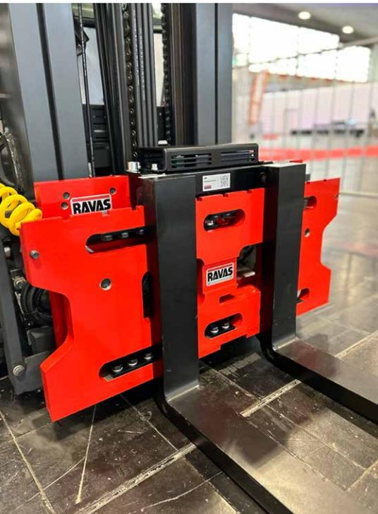
▲ Die Weigh-in-Motion-Technologie ermöglicht dem Bediener, Lasten in Bewegung zu wiegen
