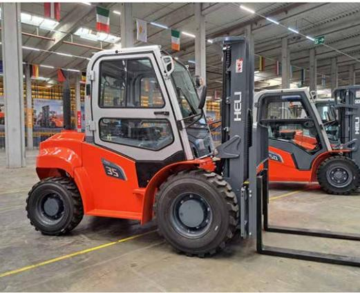
▣ Der brandneue 4x4-Geländestapler mit Isuzu-Motor und Wandlergetriebe.
