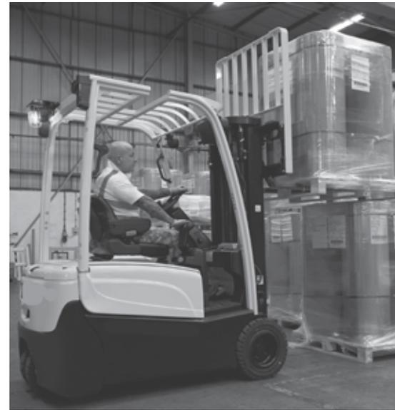
▲ Dreiradstapler mit doppelt bereifter Hinterachse: Platzsparer im Lager.
