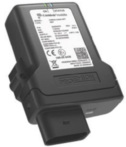
**▲** Data-Link-Baustein, der immer bei der Montage des OEM-Produktes verbaut und mit dem CanBus gekoppelt werden muss.
