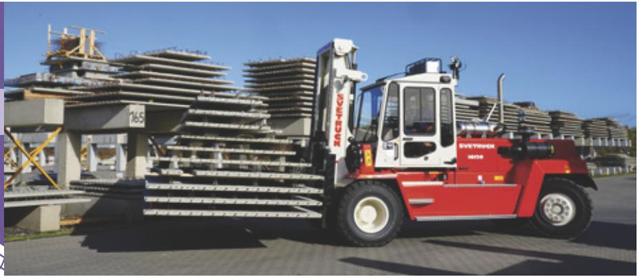
▲ Typischer 16-Tonner mit 1.200 mm LSP in einem deutschen Betonwerk.
