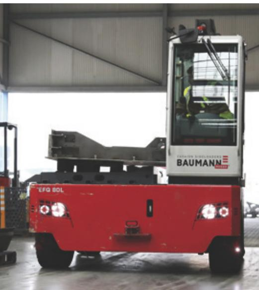
◀ Kamerasysteme erleichtern dem Bediener von Baumann-Seitenstaplern die Arbeiten mit langen Lasten. Sie bieten Sicht auf Last und Umgebung.
