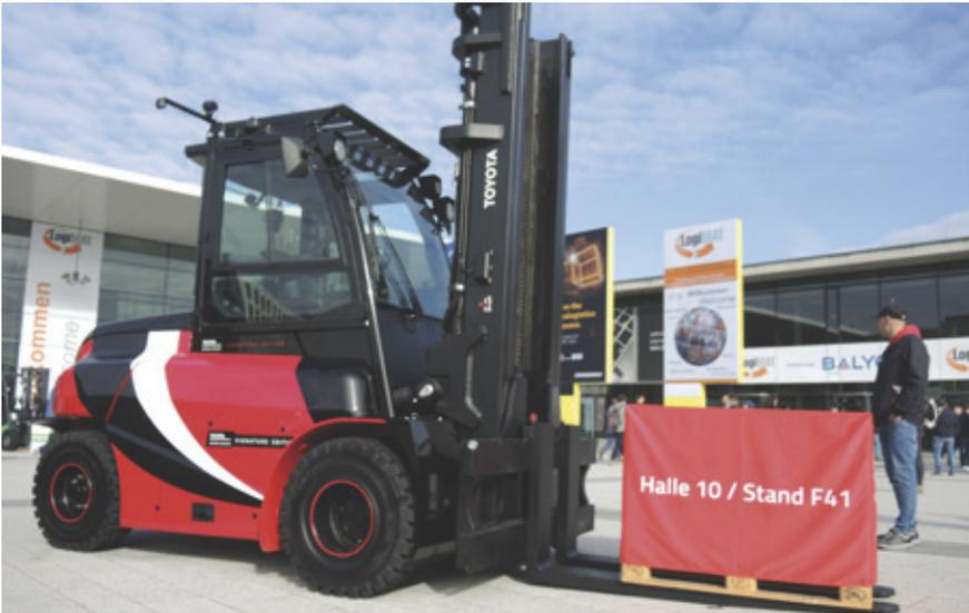
▶ Traigo80 aus dem großen Segment von Toyota in Sonderlackierung. Die Midrange-Stapler sind das obere Ende des Programmes und werden mit PzS- und Li-ION-Batterien angeboten. 600 und 900 mm LSP sind wählbar, was den Einsatz mit verschiedensten Anbaugeräten erleichtert. Eine 1.200-mm-LSP-Variante wäre aus Sicht der Redaktion eine Anregung.
