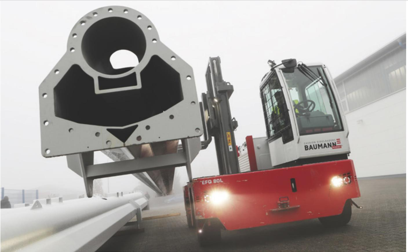
▲ Elektrischer Seitenstapler mit 8.000 kg Nutzlast. Über 60 % aller Seitenstapler liefert das in Cavaion am Gardasee ansässige Unternehmen heute mit E-Antrieb aus.
